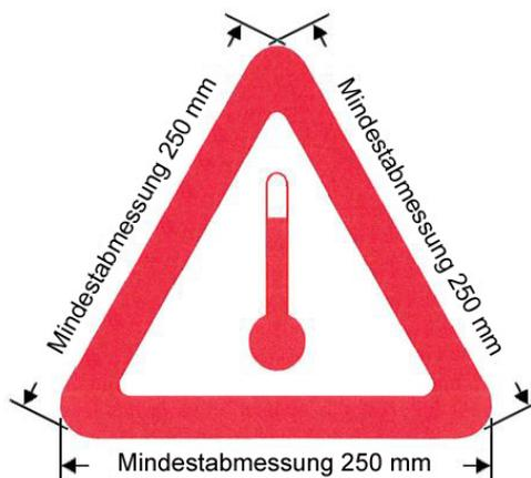
Kennzeichen für Beförderung bei erhöhter Temperatur
